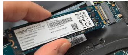
Módulo M2 y su conexión en la placa base
