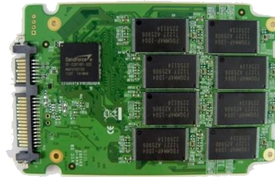
Interior dispositivo SSD SATA
