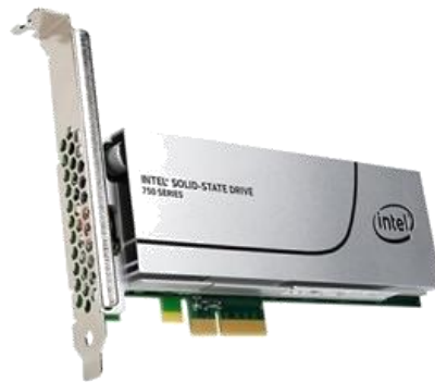
Tarjeta de expansión SSD y su conexión en placa
